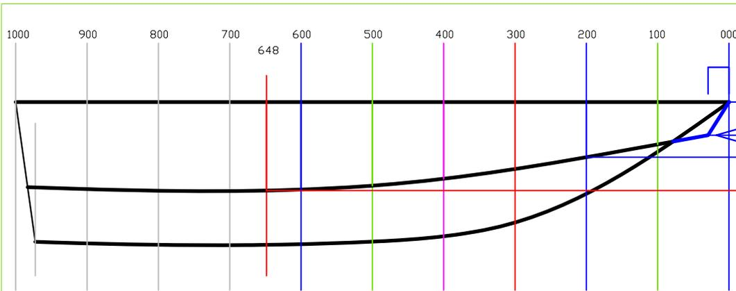
Der obere Plattengang wird bis zum Knick in einem Zylinder abgewickelt. Dieser Zylinder hat eine beliebige Grundlinie. Wir kennen aber eine Linie, die auf dem Zylinder liegt, nämlich die gewünschte Decklinie. Alle Erzeugenden sind zu einander parallel, erscheinen also in jeder beliebigen, nicht perspektivischen Ansicht ebenfalls parallel.
